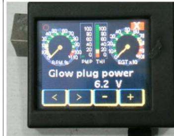
Venons-en maintenant à Glow Plug Power. Il doit être réglé le plus bas possible pour continuer à fonctionner. La valeur par défaut est 5,8/6,2 V
