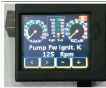
Vient ensuite le réglage de la vitesse minimale de la pompe pendant le démarrage.
